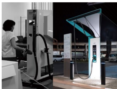
電気自動車用急速充電器と実験の様子
