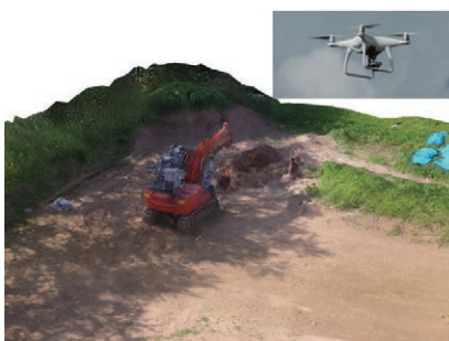
マルチロータ機を用いた三次元地形情報取得
