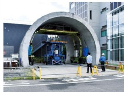
トンネルの自動点検用ロボットの開発
