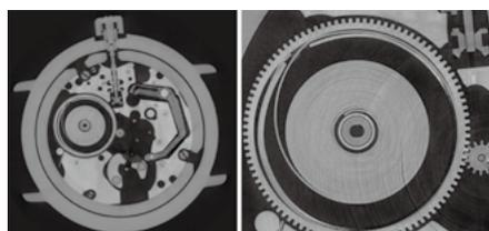
「SPring-8」にある最先端X線CTの性能を確かめるべく、機械式腕時計をスキャンしてみた時の画像。微細なパーツの1つ1つがくっきりと映し出された。
