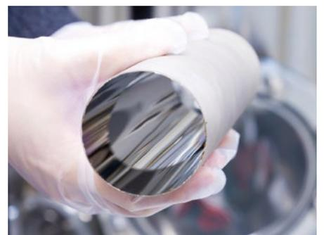
X線望遠鏡にも使用されている大型のウォルターミラー。製造装置もすべて研究室で開発した。必要なものは自分たちで作るのが三村教授のスタンスだ。
