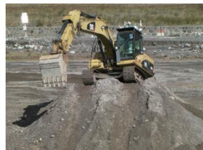
遠隔操作ロボットによる無人化施工
