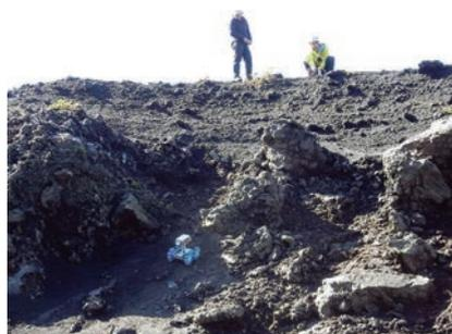
テザーを用いた小型移動ロボットの急斜面移動機構
