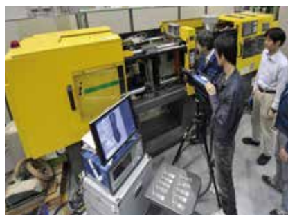
超高速ビデオによる金型内現象の可視化
