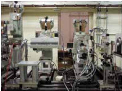
SPring-8におけるX線ミラーの評価
