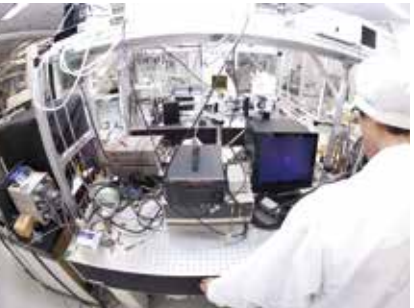
光マイクロセンサの封止性能評価実験
