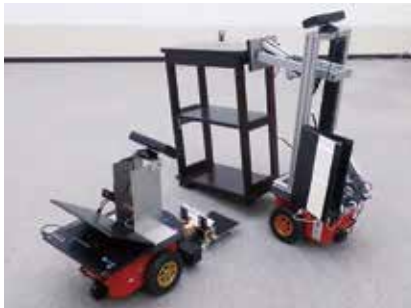
移動ロボットの物体搬送
