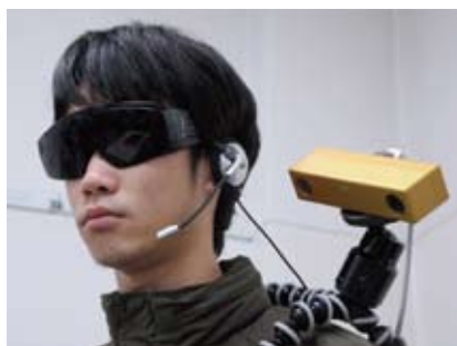
カメラを用いたウェアラブル福祉ヒューマンインタフェース
