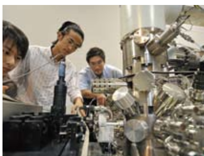
超高真空電子顕微鏡下でAFMを用いた力学計測と元素同定
