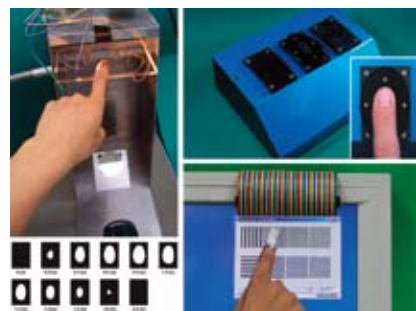
モノの手触りを伝える触感ディスプレイ
