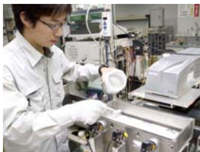
粉末焼結積層造形装置
